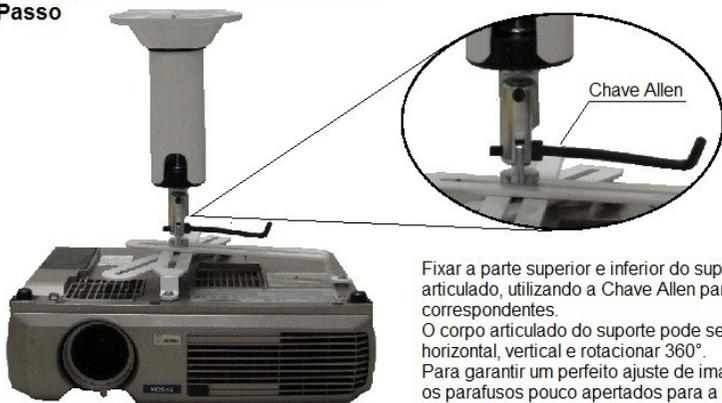
Fixar a parte superior e inferior do suporte através do corpo articulado, utilizando a Chave Allen para apertar os parafusos correspondentes. O corpo articulado do suporte pode ser movimentado nos sentidos horizontal, vertical e rotacionar 360°. Para garantir um perfeito ajuste de imagem, é aconselhável deixar os parafusos pouco apertados para a movimentação da articulação e somente apertá-los definitivamente após o ajuste final do enquadramento da imagem com a Tela de Projeção.
