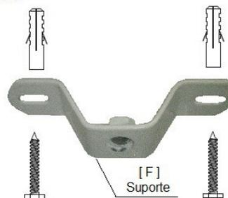
Fixar no teto (laje ou concreto) o suporte da figura, utilizando os parafusos A e buchas B.
