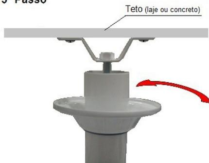
Rosquear a parte montada anteriormente ao suporte com porca que já está fixado no teto, conforme figura acima.
