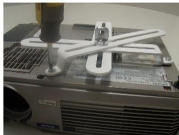
Ajustar e fixar as hastas conforme os pontos de fixação do seu projetor. Faça a regulagem do posicionamento das hastas de forma que o parafuso do corpo do suporte esteja sempre próximo ao centro do projetor, para melhor distribuição do peso. Utilizar os parafusos e arruelas C / D para fixar as hastas ao projetor.
